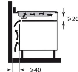
Em caso de instalação da placa de cozinha acima de uma gaveta, ou acima de um forno encastrável, respeite as dimensões indicadas nas ilustrações para assegurar uma saída de ar suficiente na frente.
