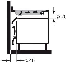
Verificare che l'aria circoli correttamente fra la parte posteriore e anteriore del piano cottura. In caso di installazione del piano cottura al di sopra di un cassetto o di un forno a incasso, rispettare le dimensioni indicate sulle illustrazioni al fine di assicurare un'uscita d'aria sufficiente dalla parte anteriore. Incollare la guarnizione di tenuta stagna su tutto il bordo del piano. Posizionare il piano cottura nel mobile.
