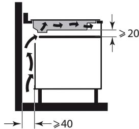
En caso de instalar la placa por encima de un cajón o un horno empotable, respete las dimensiones indicadas en las imágenes para garantizar una salida de aire suficiente por delante.
