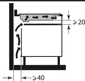
V případě instalace desky nad zásuvku, nebo nad vestavnou troubou, dodržujte rozměry uvedené na obrázcích, abyste zajistili dostatečný výstup vzduchu vpředu. Opatrně přilepte těsnění po celém okraji skla varné desky, než zahájíte vestavbu.
