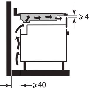
ou au-dessus d'un four encastré, respectez les dimensions indiquées dans les illustrations pour assurer une circulation d'air adéquate.
