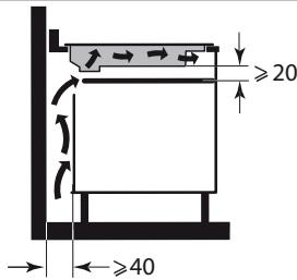
Prüfen Sie, dass die Luft zwischen der Vorder- und der Rückseite des Kochfelds gut zirkuliert. Wenn das Kochfeld über einer Schublade oder über einem einbaubaren Backofen installiert wird, halten Sie die auf den Abbildungen angegebenen Abmessungen ein, damit die Luft gut nach vorne ausströmen kann. Kleben Sie die Dichtung auf den gesamten Umfang des Kochfelds. Das Kochfeld in das Möbel einfügen.
