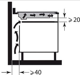
Als de kookplaat boven een lade, of een ingebouwde oven wordt geïnstalleerd, respecteer dan de afmetingen aangegeven in de afbeeldingen om een voldoende luchtafvoer te waarborgen aan de voorzijde. Lijm de pakking zorgvuldig rondom het glas van de kookplaat.
