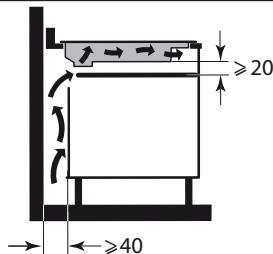
Kontroller, at luften cirkulerer korrekt mellem for- og bagende af kogepladen.
