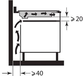
Om bordet installeras ovanför en låda, eller ovanför en inbyggd ugn, observera de mått som visas i illustrationerna för att säkerställa ett tillräckligt luftflöde.
